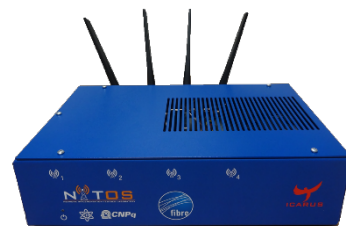
Roteador sem fio “Ícarus” personalizado para o projeto FIBRE e desenvolvido pela Universidade de Tessália - Grécia.
